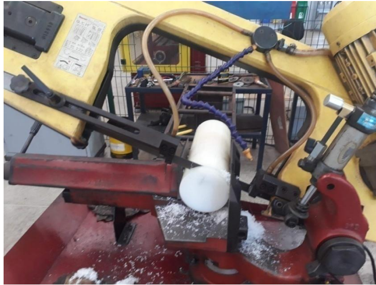
Figura 13: Fabricação dos reatores do moinho planetário.
