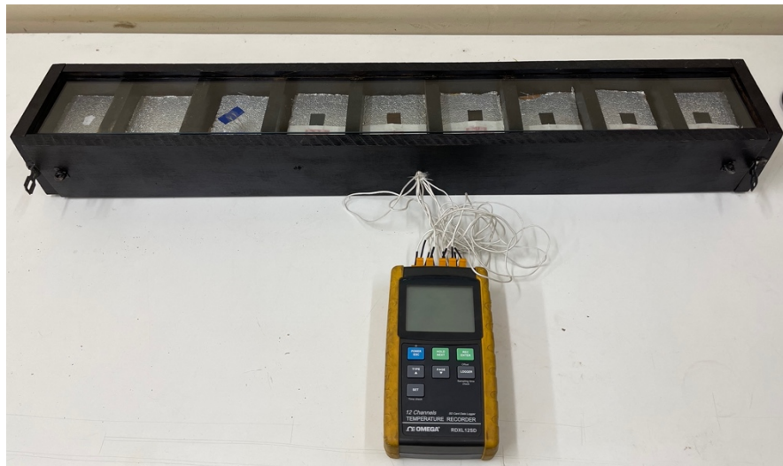
Figura 19: Superfícies seletivas em bancada de teste.
