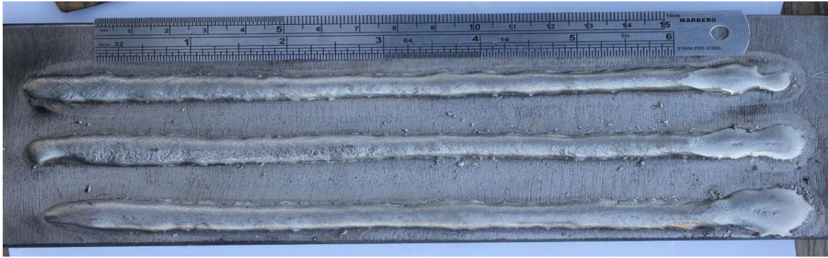
Figura 10. Cordões soldados com defasagem entre as correntes.
