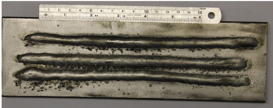
Figura 7. Cordões apresentando intensa geração de respingos resultado das soldagens realizadas nas condições sem defasagem entre os pulsos de correntes.
