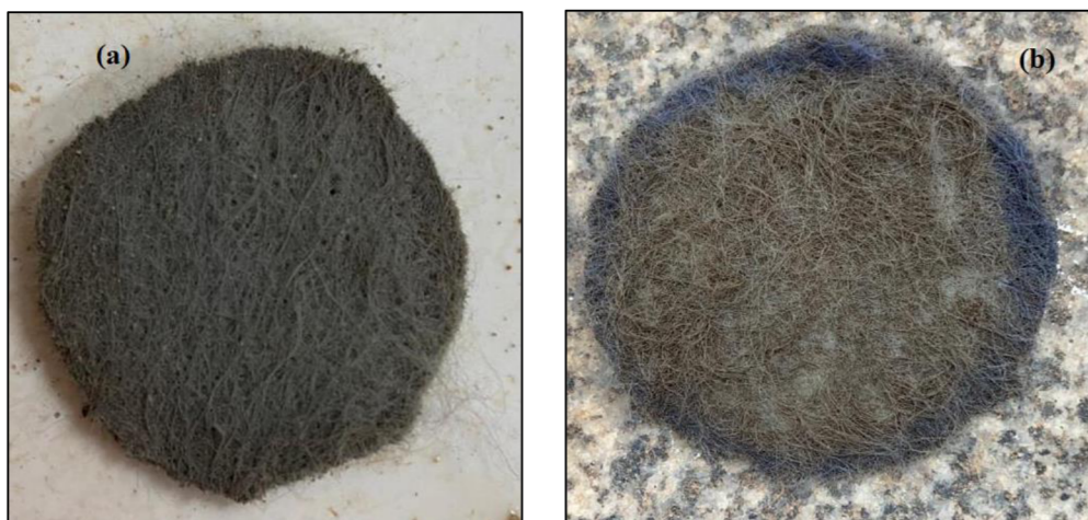
Figura 26 - Reforço de geotêxtil não-tecido após a ruptura: (a) Geot. Não-tecido de 300 g/m 2 ; (b) Geot. Não-tecido de 200 g/m 2
