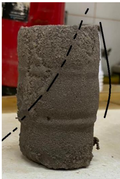
Figura 22 - Corpo de prova reforçado com duas camadas de microgrelha para a tensão de 50 kPa
