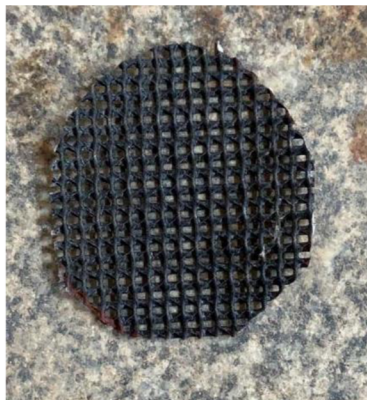
Figura 24 - Imagem da microgrelha após a ruptura dos corpos de prova
