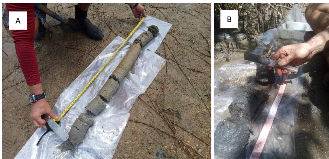
Figura 7 – Testemunho disposto sobre o solo para fracionamento (sub amostragem) dos intervalos de profundidade (A) e porção da amostra retirada com seringa (B).
