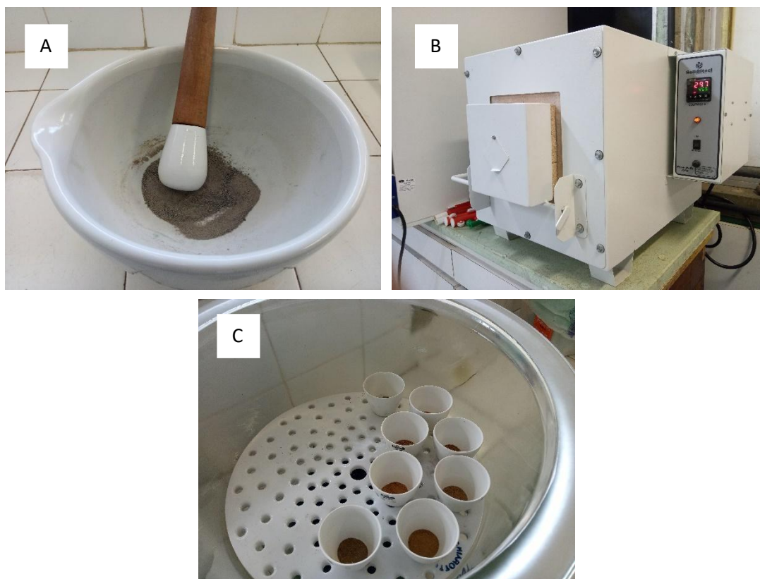
Figura 9 – Homogeneização das amostras de solo (A); Forno mufla utilizado para queima (B) e amostras em cadinhos após queima em mufla (C).
