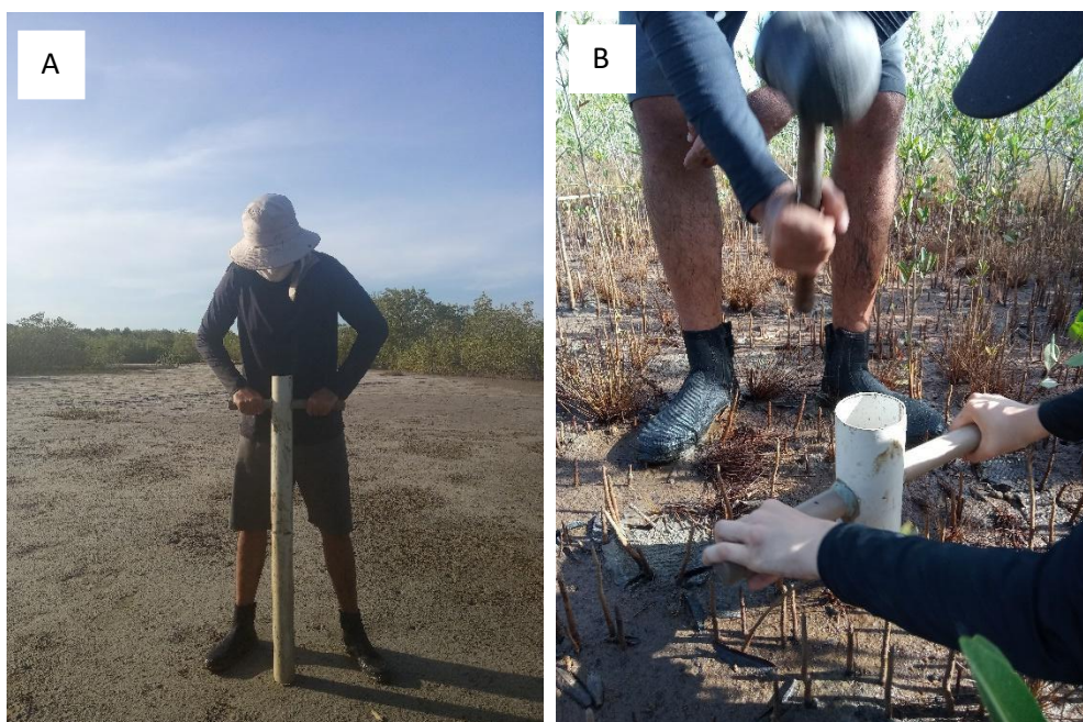
Figura 6 – Tubo de PVC utilizado durante as coletas de testemunho de solo (A) e martelo emborrachado manuseado para auxiliar a perfuração (B).
