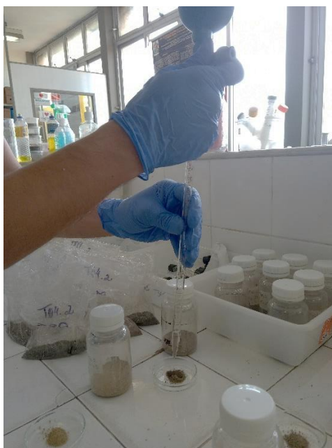
Figura 10 – Gotejamento de HCl sobre amostras de solo do manguezal do Rio Pacoti, CE.
