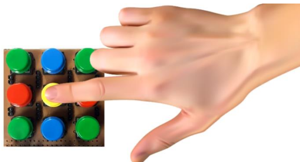
Figura 93 – Procedimento de gravação do valor de capacitância de referência
