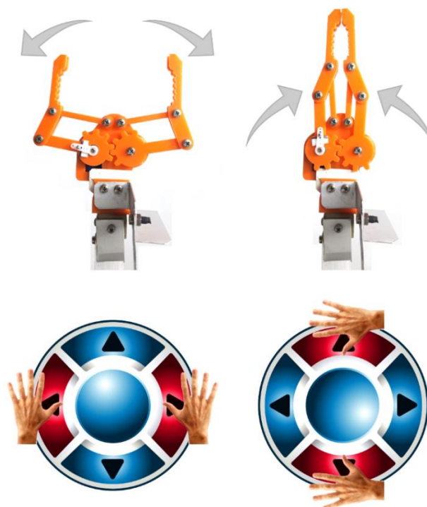
Figura 98 – Movimentos de abertura e fechamento da garra
