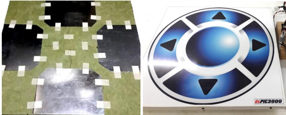
Figura 27 – Montagem dos sensores e figura impressa para cobertura
