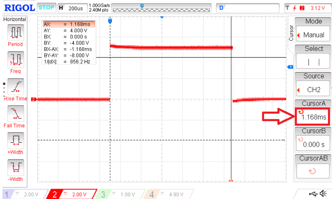
Figura 69 – Razão cíclica máxima do sinal PWM do motor do braço
