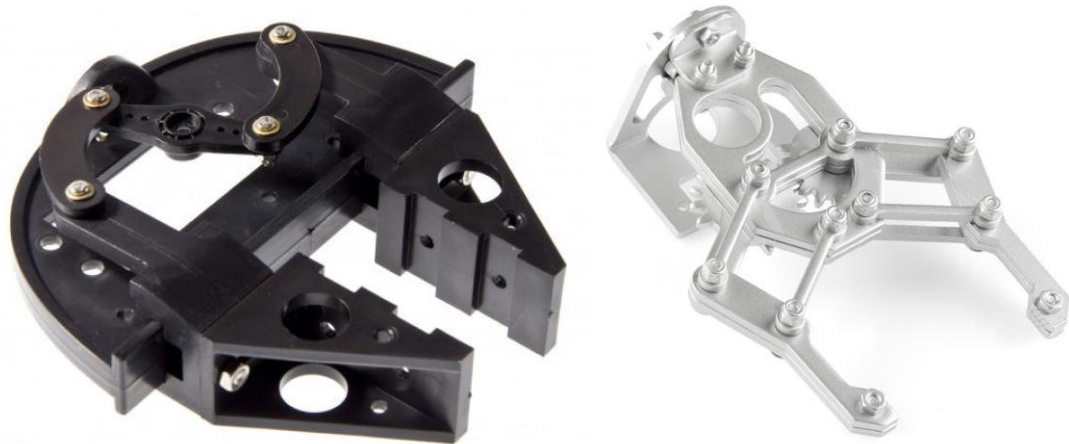
Figura 5 – Modelo de garras de dois dedos
