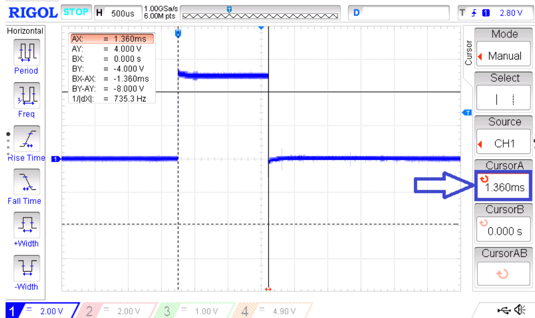
Figura 67 – Razão cíclica máxima do sinal PWM do motor da base
