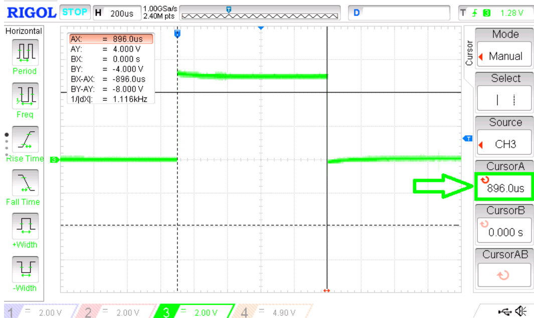
Figura 71 – Razão cíclica máxima do sinal PWM do motor da garra
