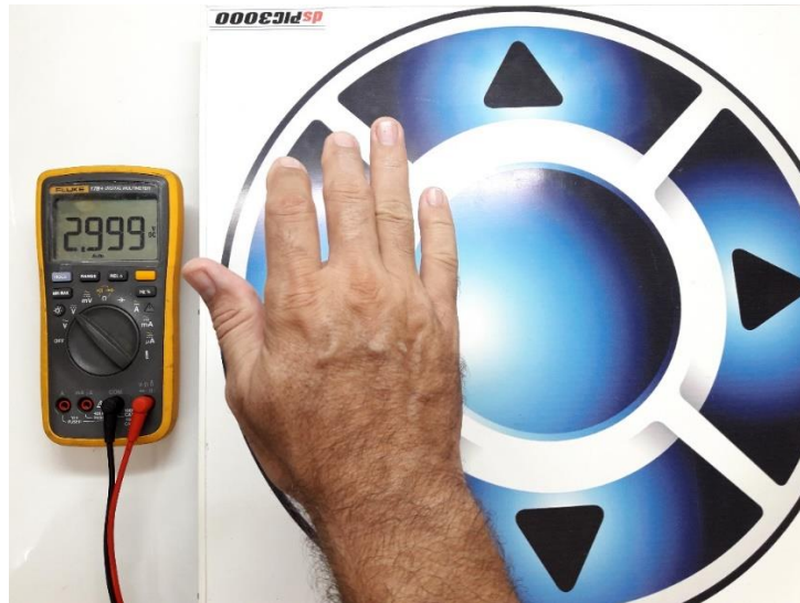
Figura 56 – Tensão no terminal LEVEL do MC34940
