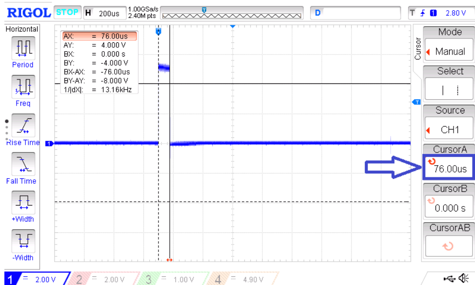
Figura 66 – Razão cíclica mínima do sinal PWM do motor da base
