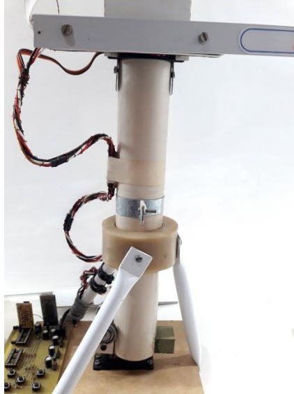
Figura 76 – Primeiro elo do braço robótico
