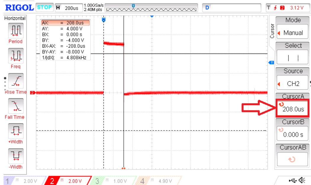
Figura 68 – Razão cíclica mínima do sinal PWM do motor do braço
