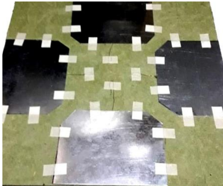
Figura 22 – Fixação das placas na base de madeira
