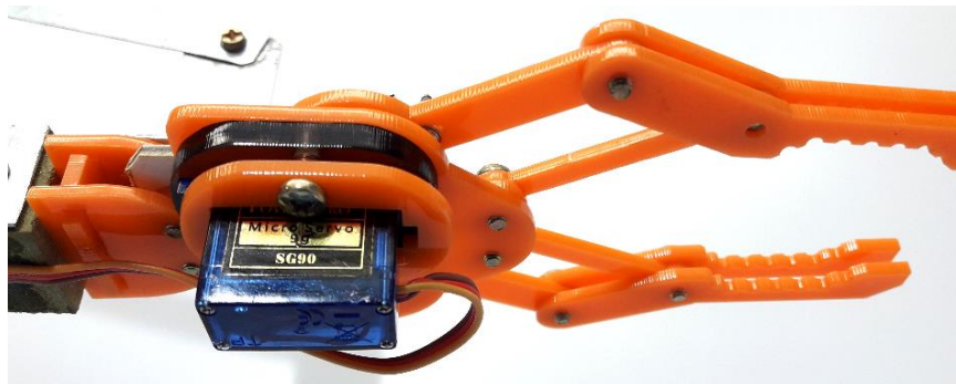
Figura 81 – Servomotor utilizado na garra robótica
