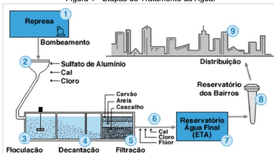
Figura 1 - Etapas de Tratamento da Água.
