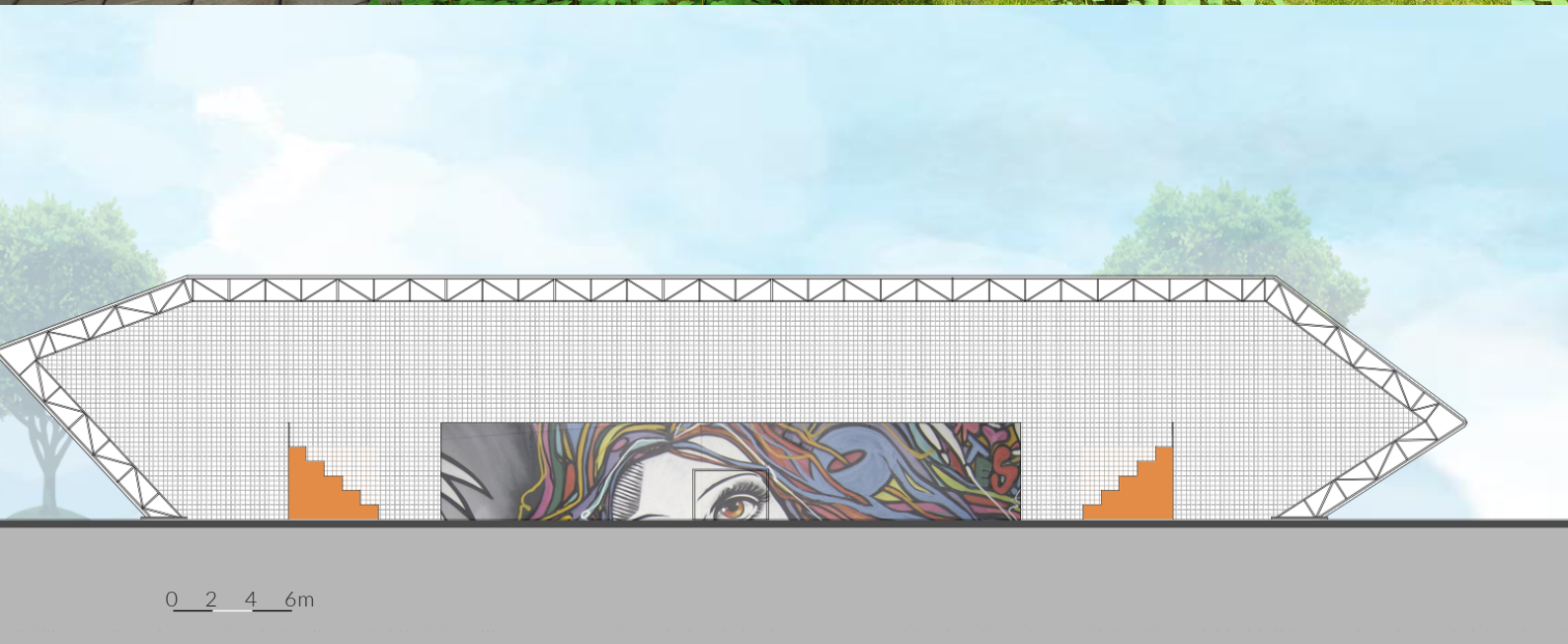
Corte que esquematiza a estrutura metálica espacial. A cobertura com 12m de altura, garante um espaço adequado aos mais variados tipos de jogos.
