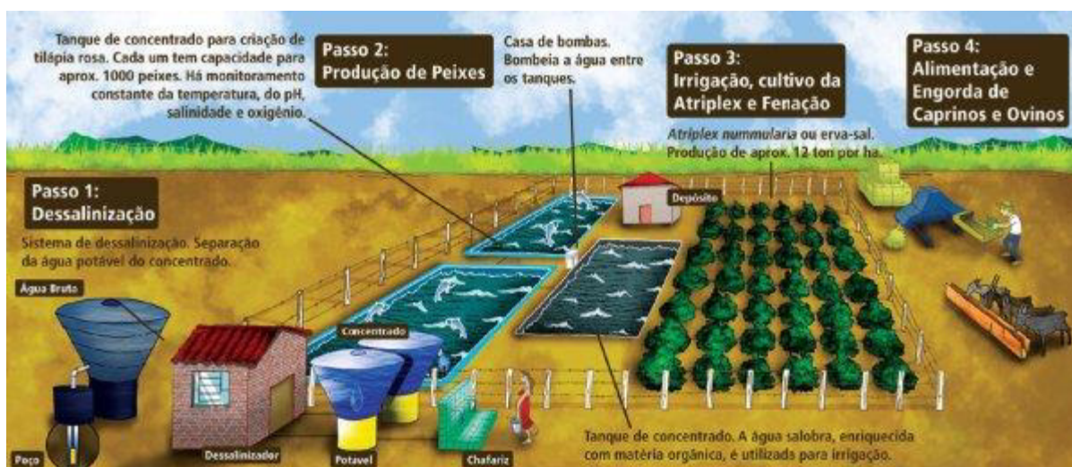
Figura 13: Sistema de dessalinização de água do Projeto Água Doce.
