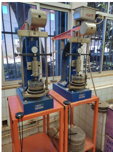
Figura 5 - Prensas de adensamento
