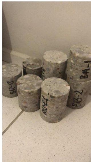
Figura 25 - CP's retificados para ensaio de resistência à compressão
