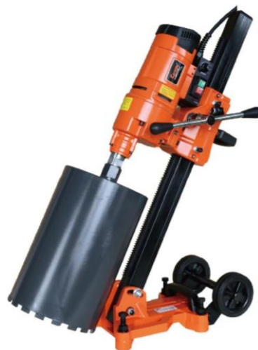
Figura 6 - Equipamento extrator de testemunhos
