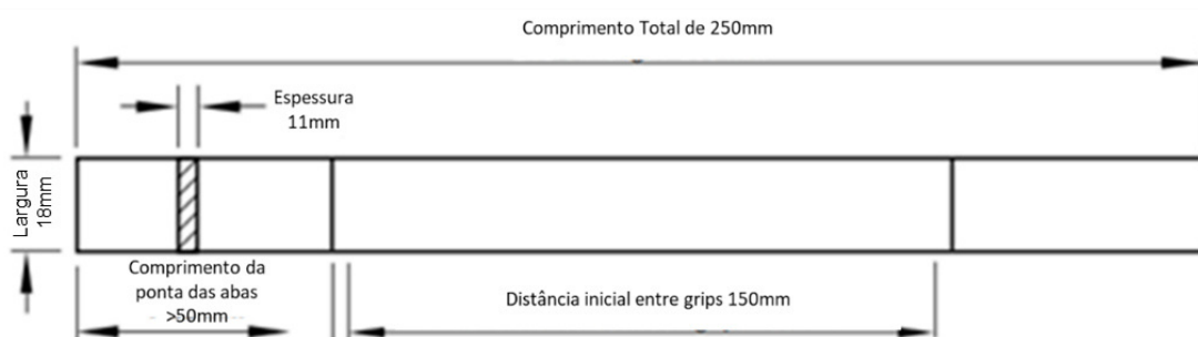
Figura 21 Dimensões dos corpos de prova
