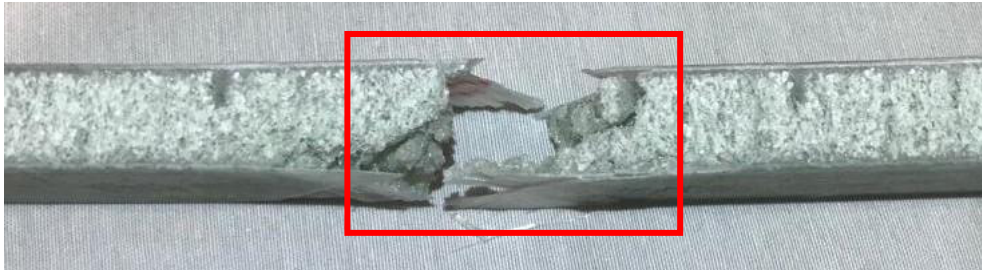
Figura 24 Corpo de Prova tipo B fraturado
