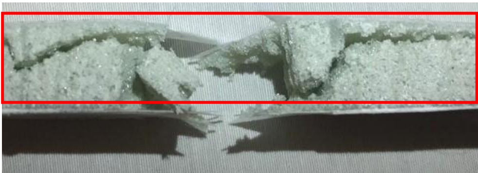
Figura 25 Corpo de Prova tipo C fraturado
