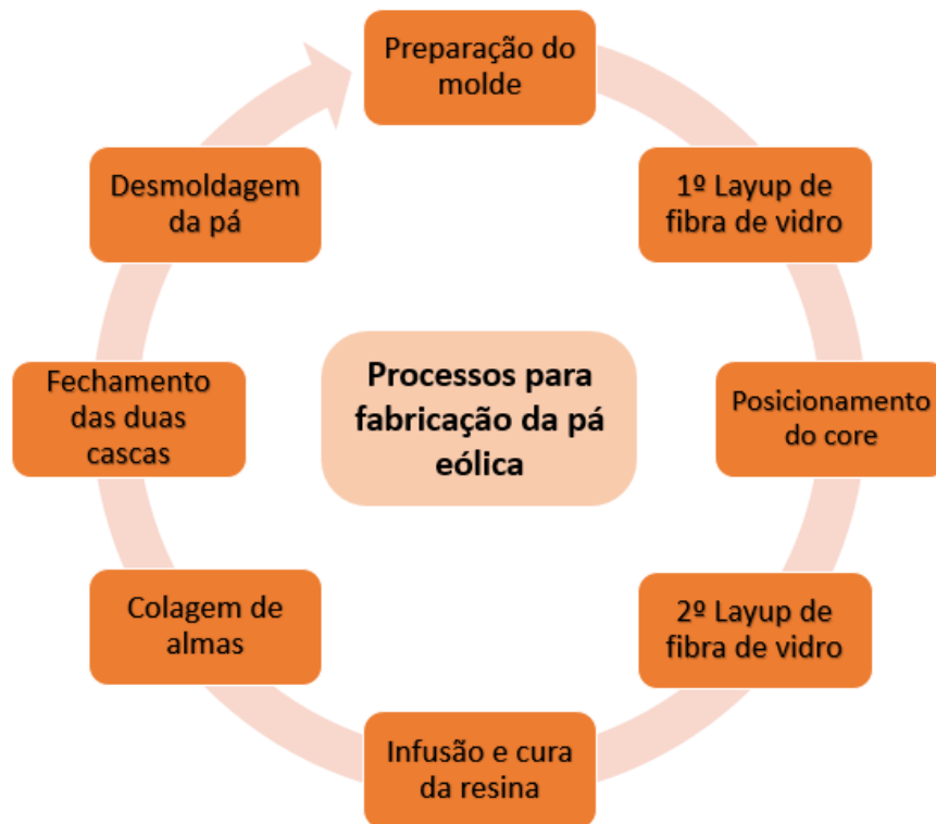
Figura 9: Fluxograma da fabricação de uma pá eólica
