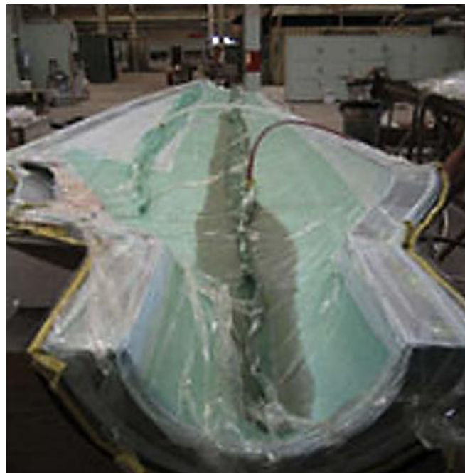
Figura 7: Processo de infusão em uma casca da pá eólica.
