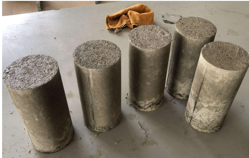
Figura 51 — Corpos de prova de referência.
