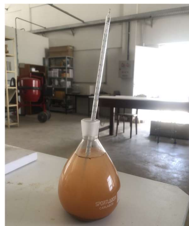
Figura 22 — Aferição da temperatura do conjunto.
