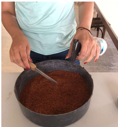
Figura 32 — Pré-molhagem do RCV.
