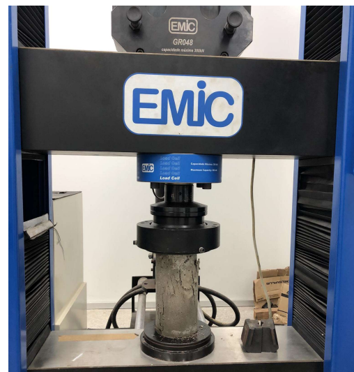
Figura 44 — Ensaio de Compressão axial.
