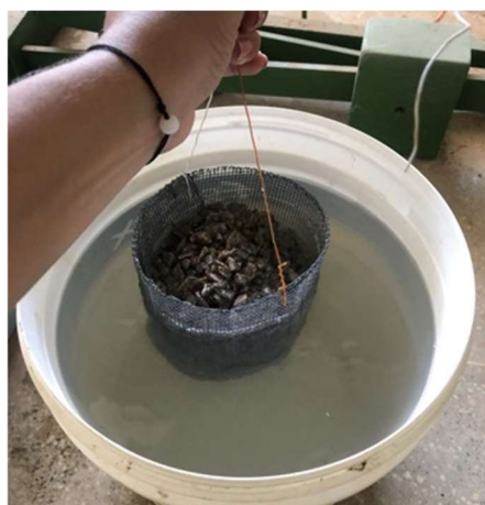
Figura 23 — Obtenção da massa da brita em água.
