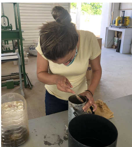
Figura 39 — Aplicação de desmoldante.
