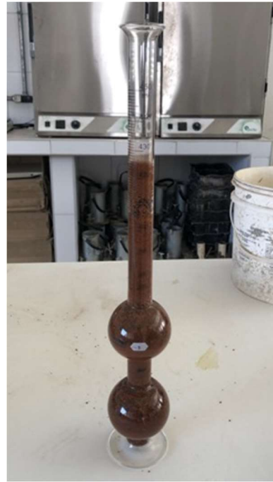
Figura 20 — Ensaio do Frasco de Chapman para o resíduo de cerâmica vermelha.
