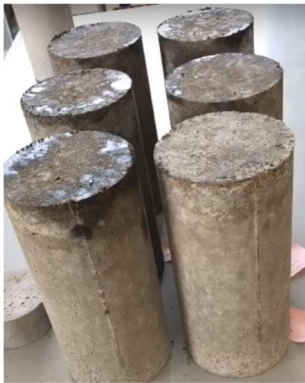
Figura 57 — Corpos de prova 5% RCV pré-molhado.
