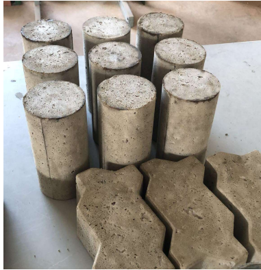
Figura 52 — Corpos de prova 5% RCV com aditivo.
