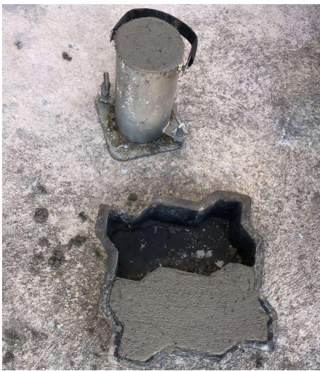
Figura 41 — Corpos de prova moldados.
