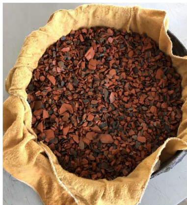
Figura 24 — RCV saturado com superfície seca.
