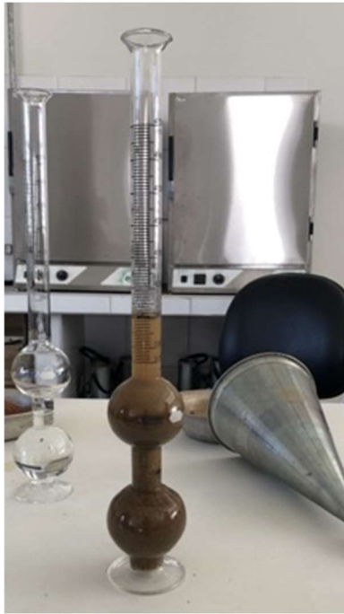
Figura 19 — Ensaio do Frasco de Chapman para a areia natural.
