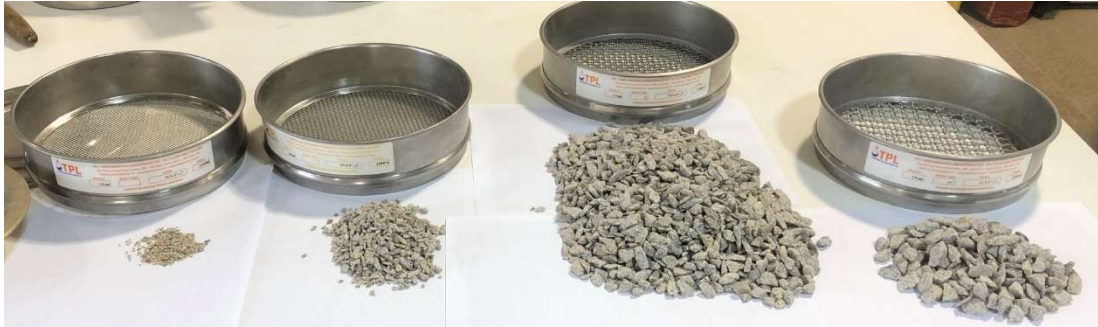
Figura 16 — Ensaio de granulometria com a brita 0.
