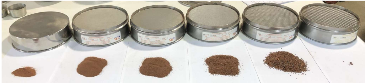
Figura 18 — Ensaio de granulometria com o resíduo de cerâmica vermelha.
