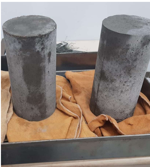
Figura 43 — Secagem superficial dos corpos de prova.
