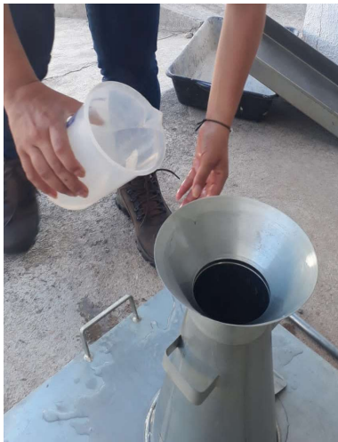
Figura 35 — Umidificação do molde e da placa de base.
