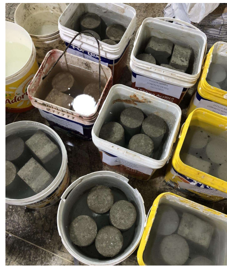
Figura 42 — Processo de cura úmida.
