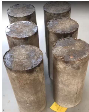
Figura 58 — Corpos de prova 15% RCV pré-molhado.
