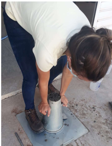
Figura 37 — Retirada do molde.
