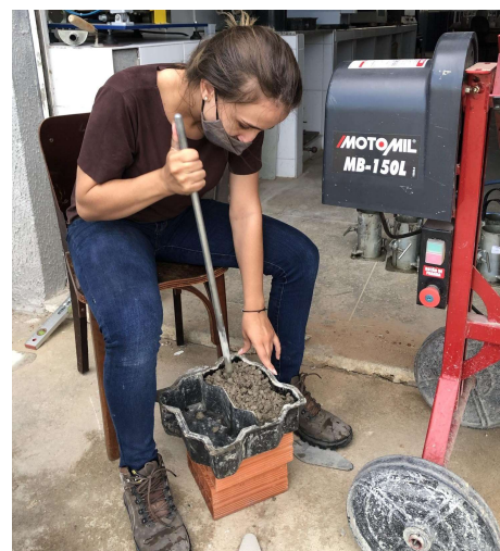
Figura 40 — Adensamento manual do concreto.
