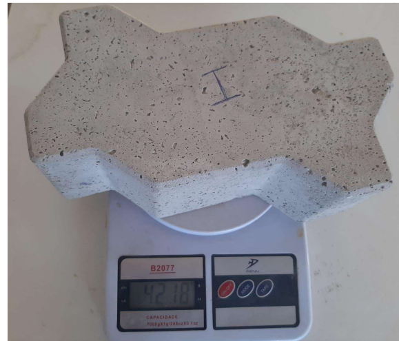
Figura 46 — Corpo de prova após secagem em estufa.
