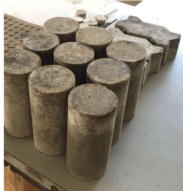
Figura 53 — Corpos de prova 15% RCV com aditivo.
