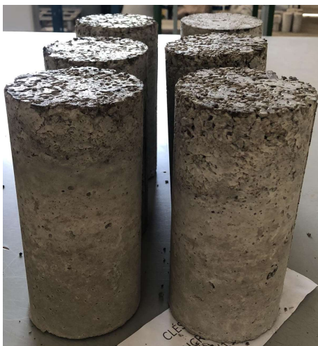
Figura 55 — Vista lateral de corpos de prova com RCV4,75.
