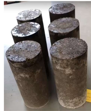
Figura 59 — Corpos de prova 25% RCV pré-molhado.
