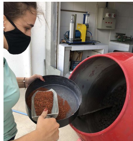
Figura 33 — Inserção do RCV na mistura.
