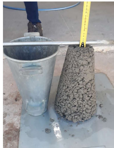
Figura 38 — Medida do abatimento com a trena.
