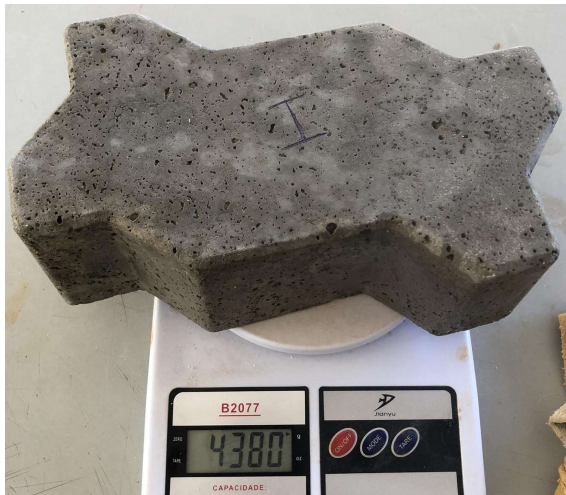
Figura 45 — Corpo de prova saturado com superfície seca.
