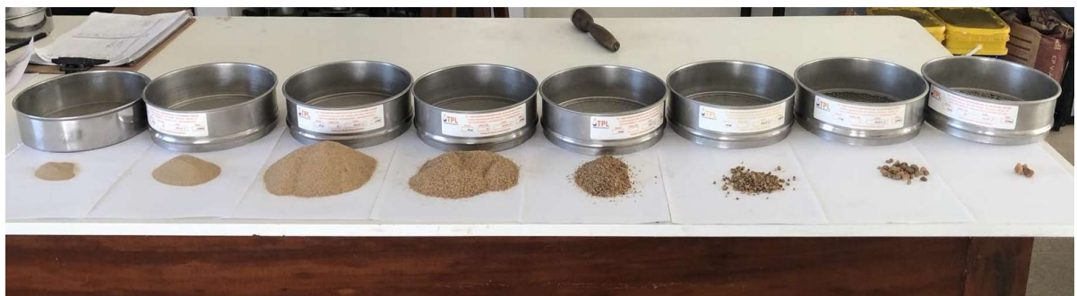
Figura 17 — Ensaio de granulometria com a areia natural.
