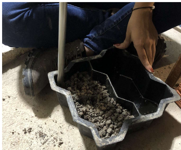
Figura 50 — Moldagem de corpo de prova 16 faces com 25% RCV.
