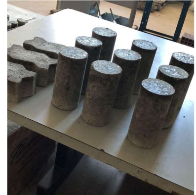
Figura 54 — Corpos de prova 25% RCV com aditivo.
