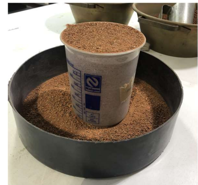
Figura 28 — Determinação da massa unitária do resíduo de cerâmica vermelha.
