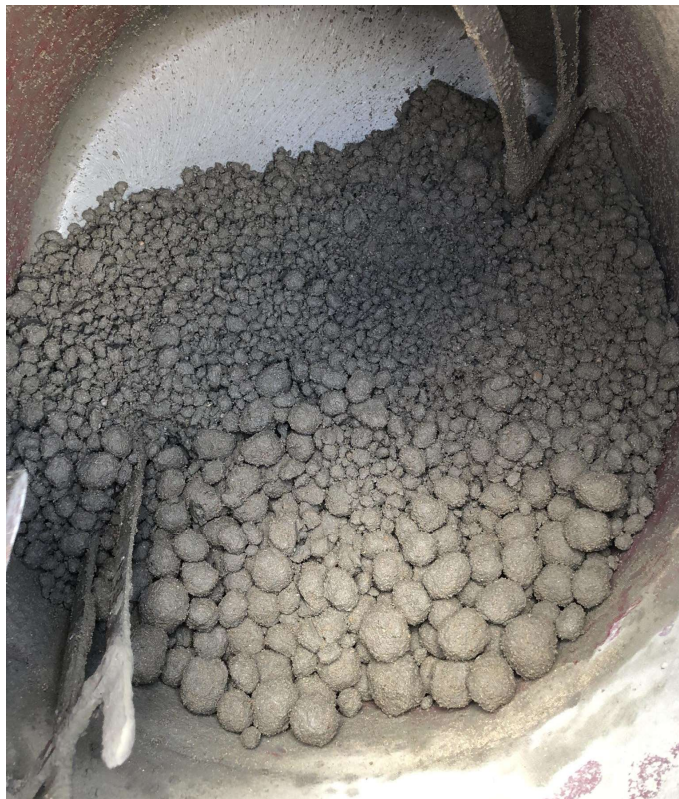
Figura 49 — Formação de bolas de cimento durante a mistura.
