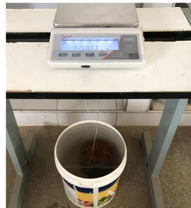
Figura 25 — Obtenção da massa do RCV em água.
