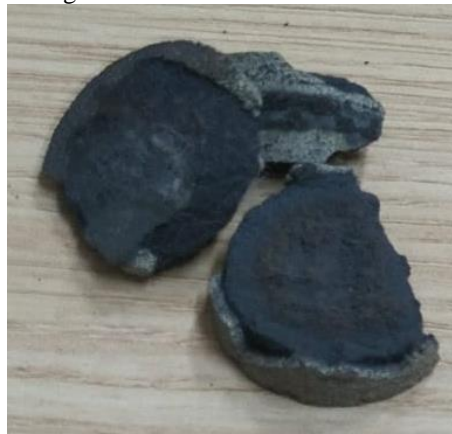
Figura 12: CP sinterizado a 1100 °C
