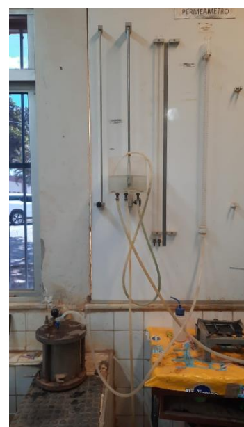
Figura 18 – A) Processo de saturação dos corpos de prova; B) Esquema de saturação
