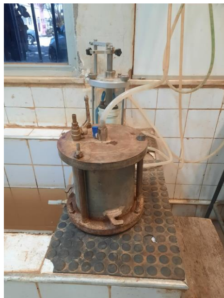
Figura 18 – A) Processo de saturação dos corpos de prova; B) Esquema de saturação
