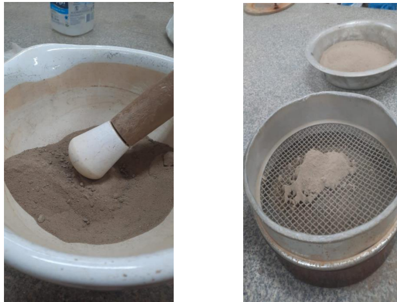
Figura 14 – A) Destorroamento da amostra de solo natural; B) Peneiramento das amostras de solo
