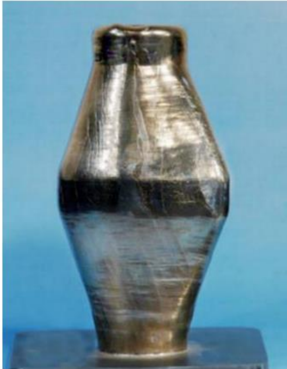
Figura 18– Peça manufaturada através da técnica EBF
