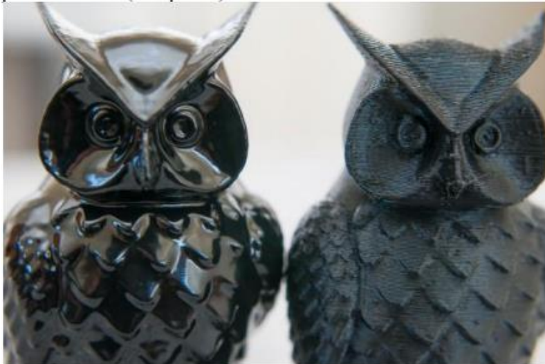
Figura 23 – Objeto com o pós-processamento (esquerda) e sem o pós-processamento (direita)
