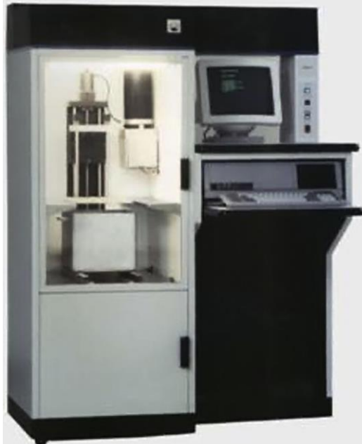
Figura 3 – A primeira máquina de MA comercializada: SLA-1
