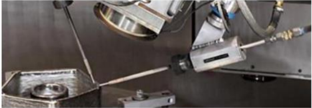
Figura 20 – Processo EBAM composta de duplo arame.
