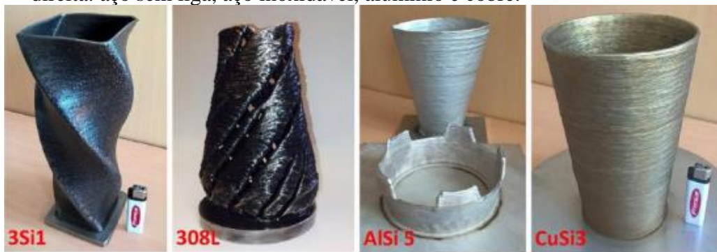
Figura 22 – Exemplos de peças produzidos por CMT. Da esquerda para direita: aço sem liga, aço inoxidável, alumínio e cobre.
