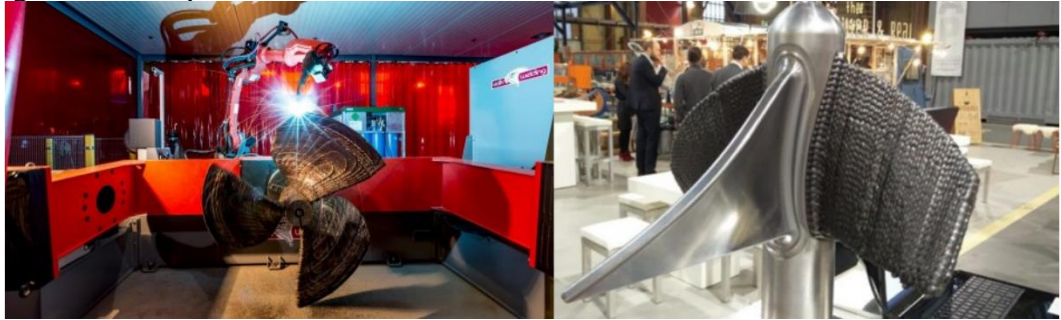
Figura 16 – Propulsor marítimo fabricado utilizando MADA
