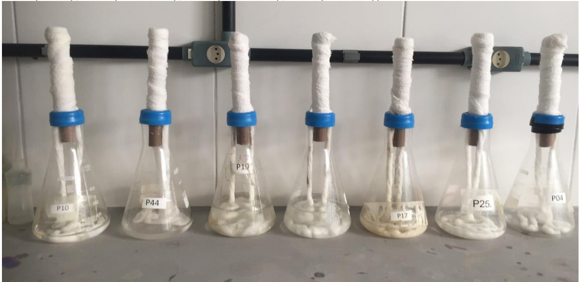
Figura B1 – Velas úmidas (da esquerda para direita P10 (UFC), P44 (Branco), P19 (Deck), P42 (Deck), P17 (16º andar), P25 (10º andar), P04 (4º andar)).
