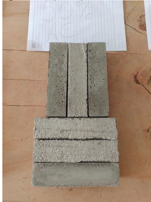
Figura 7– Corpos de prova desmoldados.
