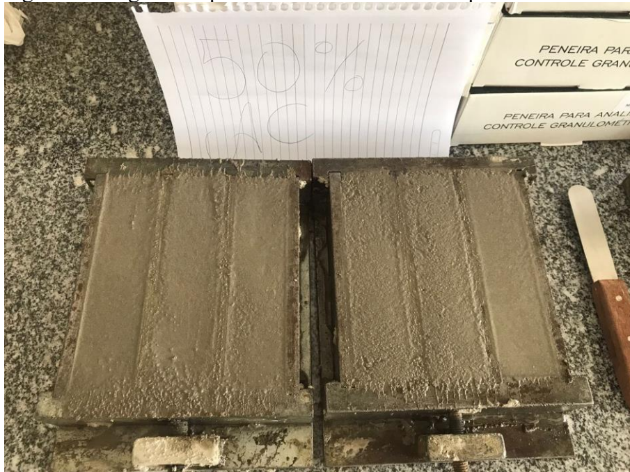
Figura 6 – Argamassa para revestimento em molde prismático 4x4x16.
