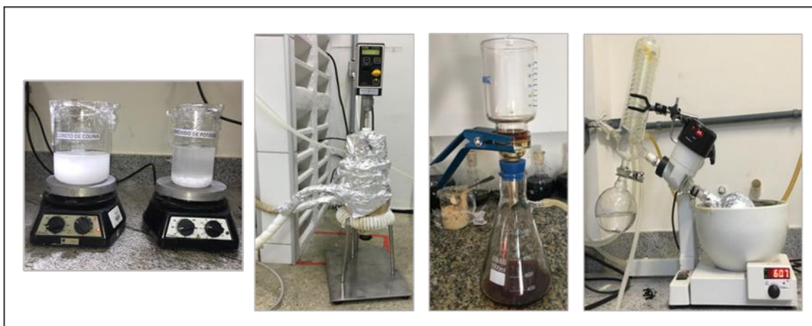
Figura 6 – Aparato experimental na produção do líquido iônico hidróxido de colina [ChOH].
