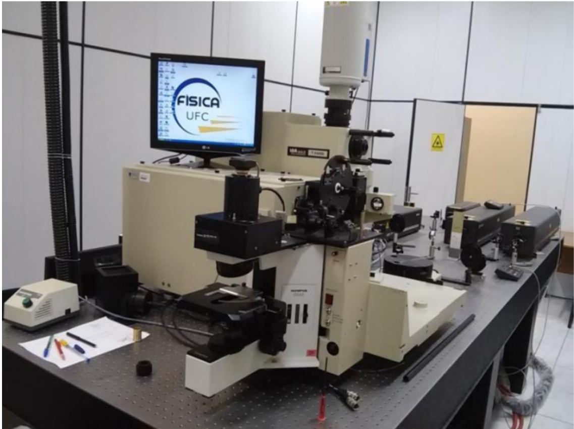
Figura 22 – Espectrômetro T64000, CCD e microscópio utilizado nos experimentos de espectroscopia Raman à temperatura ambiente e em baixas temperaturas
