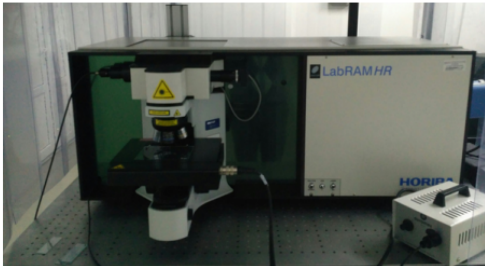
Figura 23 – Espectrômetro LabRAM HR utilizado para as medidas sob altas pressões
