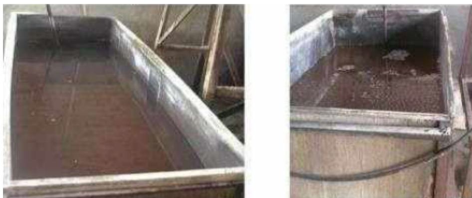
Figura 28 - Tanques para imersão de tratamento
