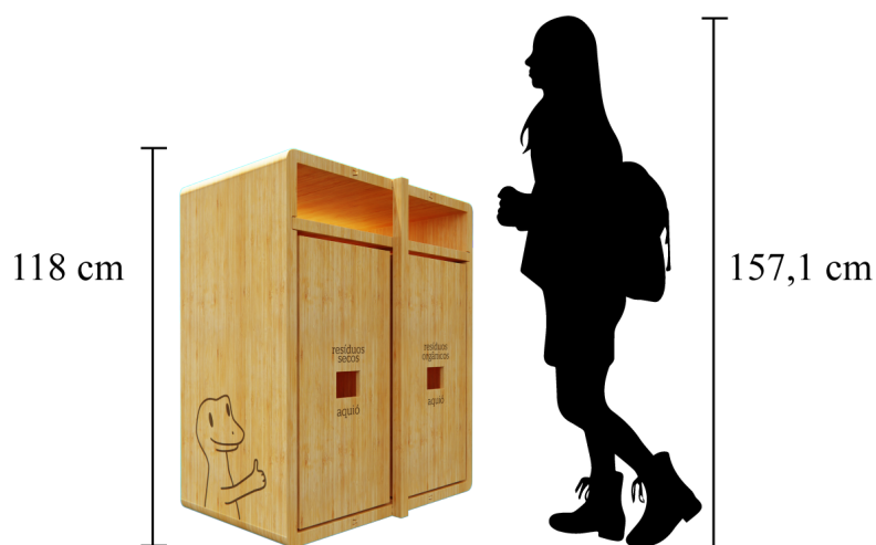
Figura 41 - Comparação entre a altura do coletor de resíduos Alió e altura média de menina de 13 anos
