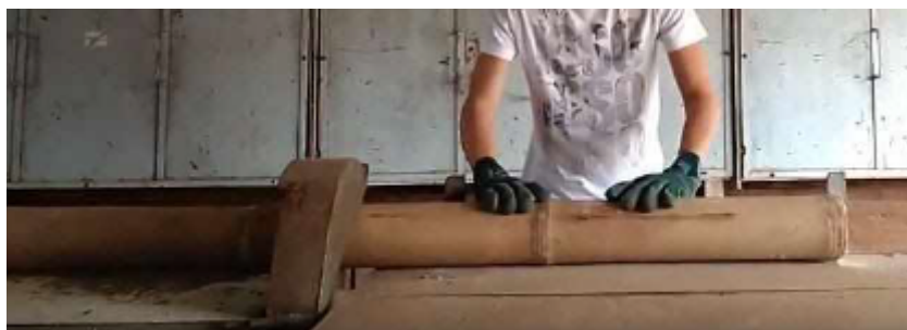
Figura 24 - Corte transversal com serra circular
