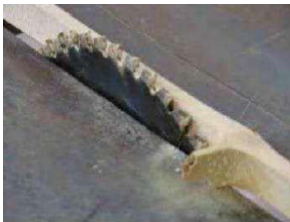
Figura 26 - Retirada dos nós no das ripas de bambu
