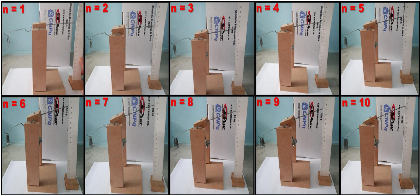
Figura 32 – Registros dos deslocamentos \Delta h como função do número de cliques colocados na balança com braços e escala.
