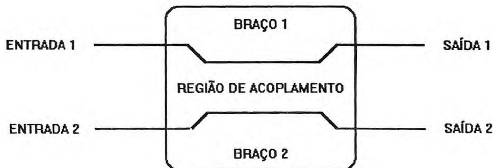
*Figura (7-1) Esquema do acoplador direcional*
