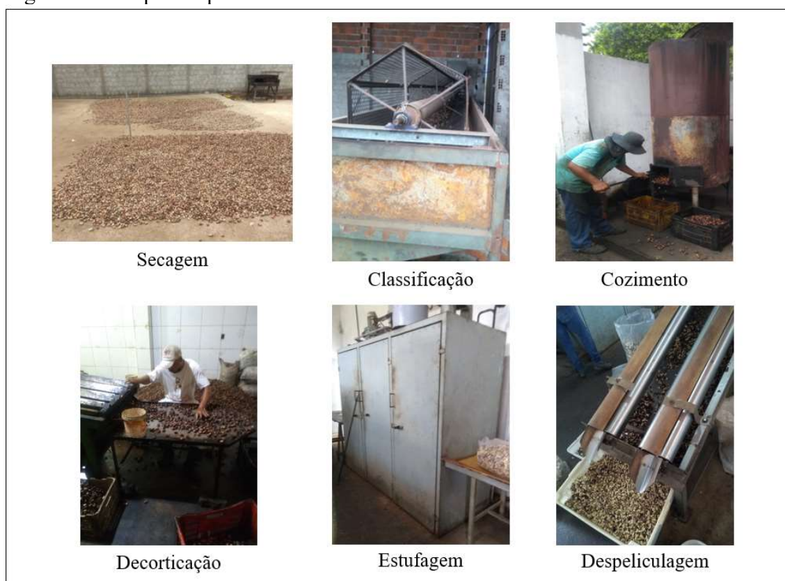
Figura 14 – Etapas do processamento de castanha em minifábricas
