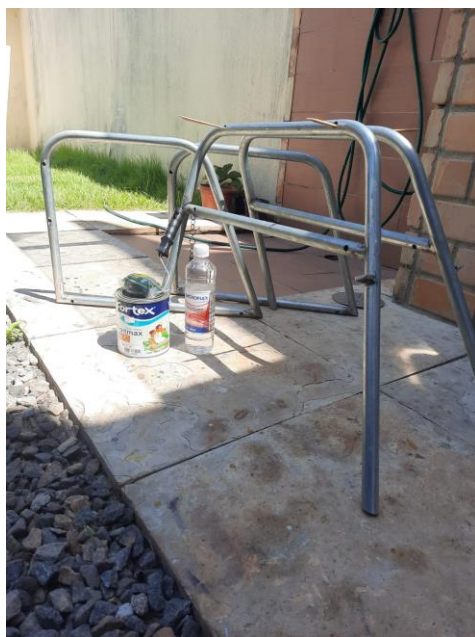
Figura 91: Preparação para pintura da estrutura metálica
