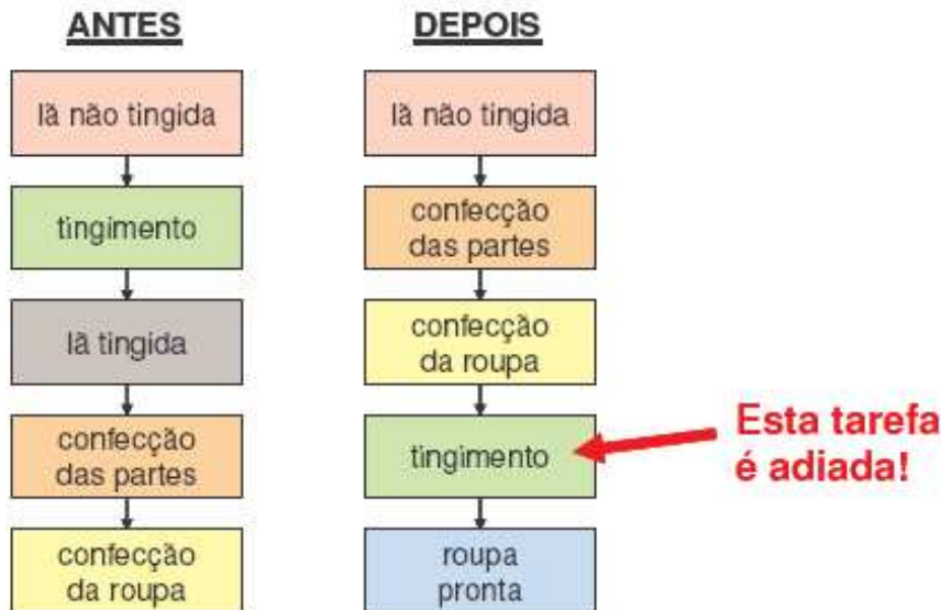
FIGURA 2 – Adoção do postponement no processo produtivo da Benetton. Fonte: Dapiran (1992 apud GRAEML, 2004, p. 151)
