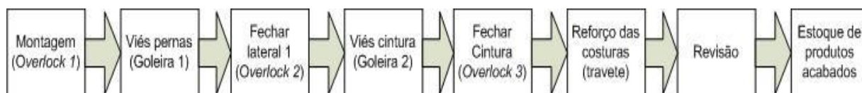
FIGURA 6 – Atividades causadoras de defeitos. Fonte: elaborado pelo autor.
