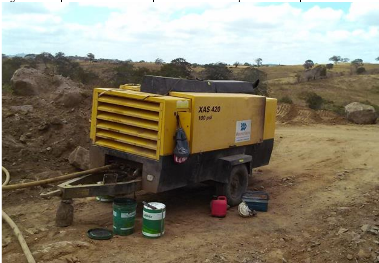
Figura 8: Compressor de ar utilizado para acionamento da perfuratriz rotopercussiva
