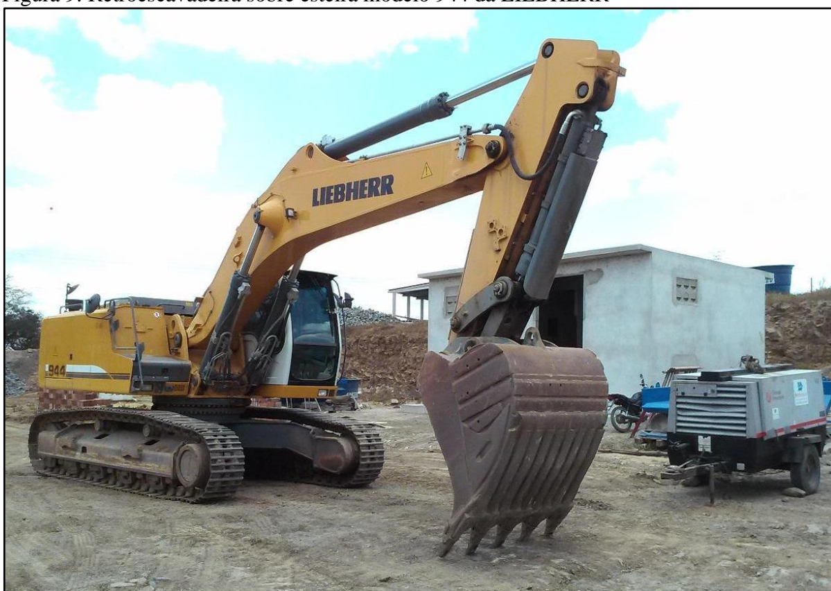
Figura 9: Retroescavadeira sobre esteira modelo 944 da LIEBHERR
