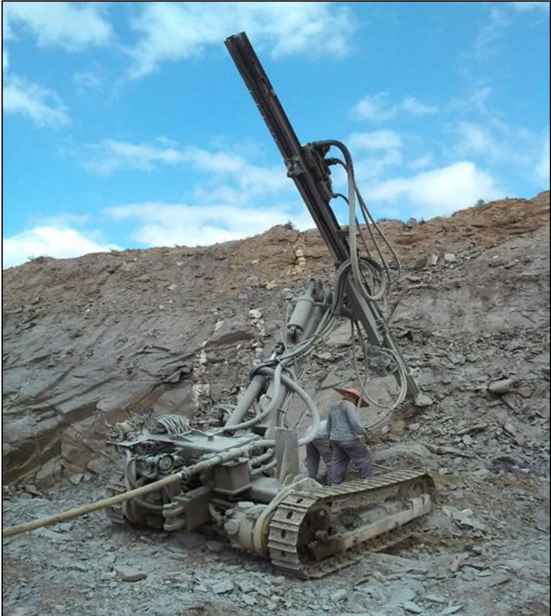
Figura 7: Perfuratriz rotopercussiva utilizada na perfuração de gipsita
