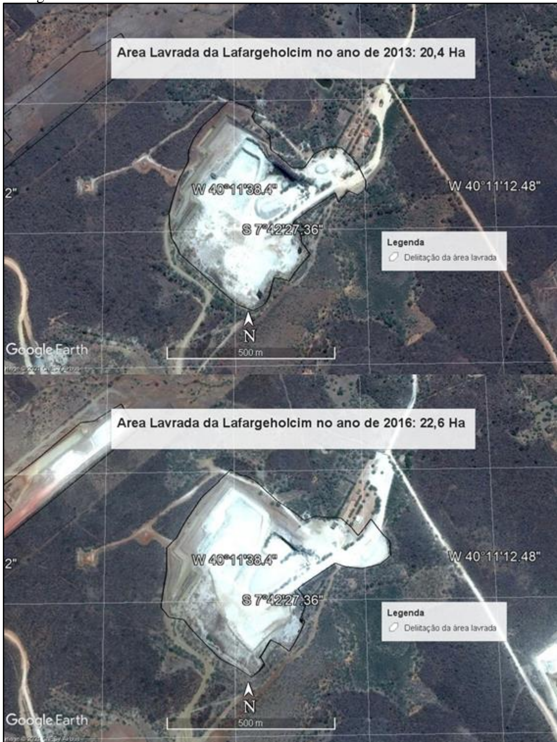
Figura 47: Comparação dos anos de 2013 e 2016 no Google Earth Pro da mineradora Lafargeholcim
