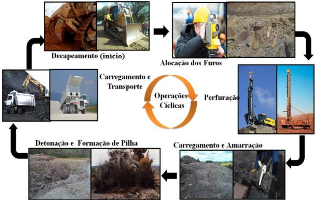
Figura 6: Operações mineiras de perfuração, detonação, carregamento e transporte de rochas.
