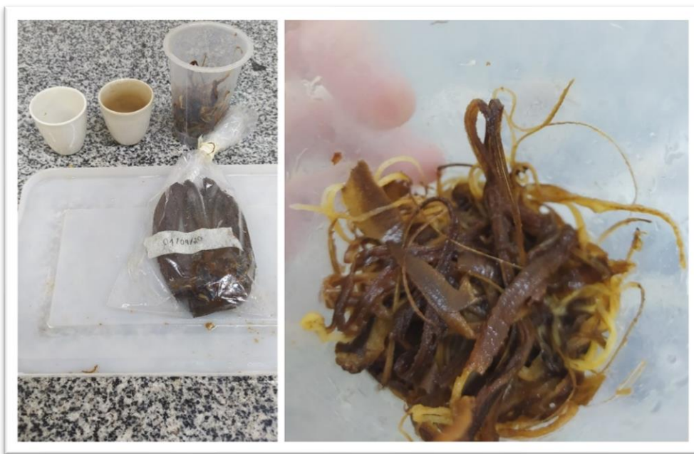
Imagem 24 — Separação das fibras da casca de banana.
