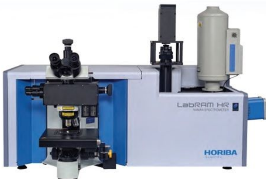
Figura 17 – Espectrômetro LabRAM HR Evolution HORIBA com Dewar acoplado.
