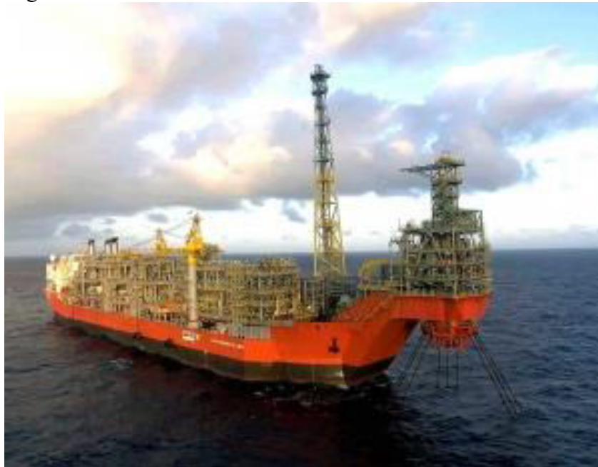
Figura 3 - FPSO Pioneiro de Libra com turret externo frontal
