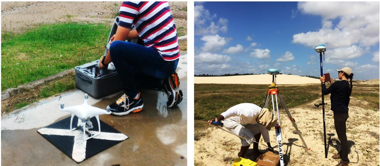
Figura 6. Veículo Aéreo Não-Tripulado – Phantom 4 (DJI Technology Co) sobre esteira de marcação de Pontos de Controle (à esquerda). Demonstração de uso do equipamento RTK Trimble R10 GNSS (à direita). Fonte: o Autor.
