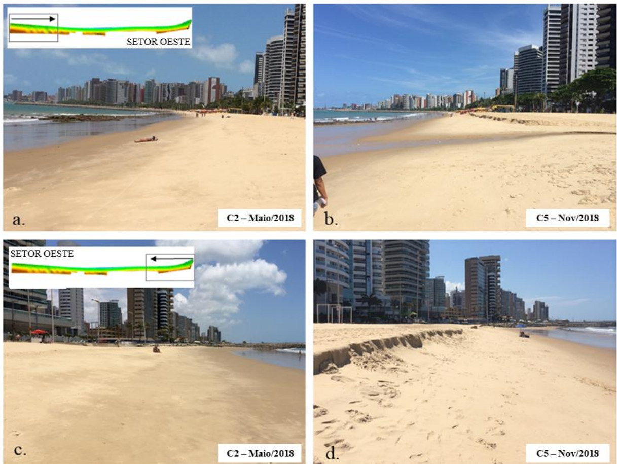
Figura 21. Mudanças no perfil praiado do setor Oeste, o mais representativo visualmente em relação às variações topográficas. Evidencia-se a formação de uma escarpa bem delimitada em Novembro/18, logo após a ocorrência de um evento de ressaca. Fonte: o Autor.
