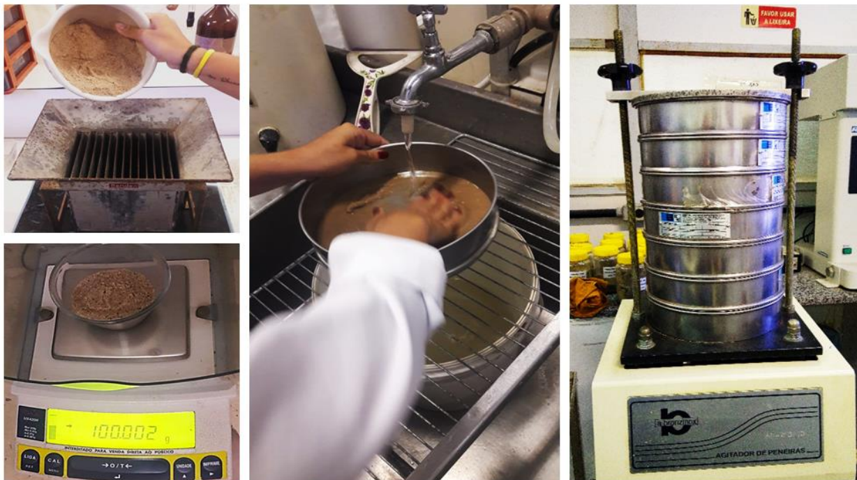
Figura 8. Demonstração do processo de análise granulométrica, com quartejamento (à esquerda acima), pesagem (à esquerda abaixo), peneiramento úmido (ao centro) e peneiramento mecânico (à direita). Fonte: o Autor.
