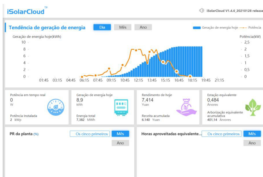
Figura 15 – Print do dashboard do monitoramento remoto de um inversor string .
