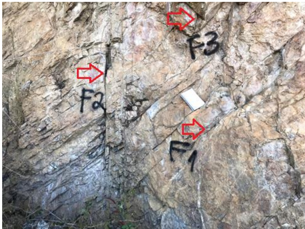
Figura 20: Afloramento 04 estudado com três famílias de fraturamento F1, F2 e F3 com nível elevado de persistência e orientações respectivamente ESE-WNW, NE-SW e NNE-SSW. Coordenadas: Longitude UTM: 355.155 m E e Latitude UTM: 9.334.622 m S, ZONA 24 S
