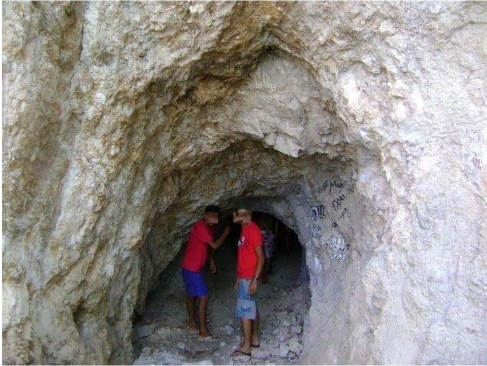
Figura 4: Embocadura do ádito de acesso à frente de lavra
