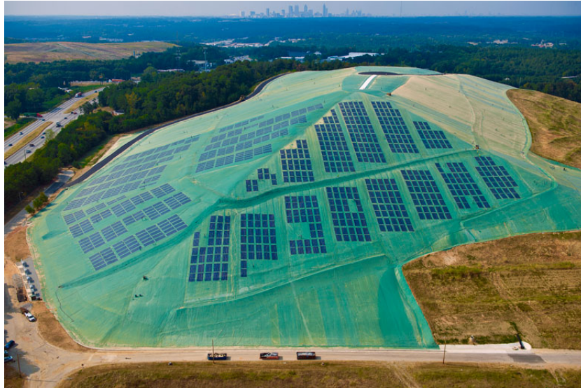
Figura 9 – Aterro sanitário de Hickory Ridge (EUA) com cobertura de geomembrana solar
