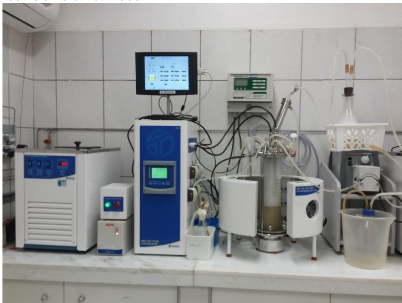
Figura 6 - Configuração do biorreatorairlift (Tecnal, modelo cruzeta) de 3L de volume útil utilizado
