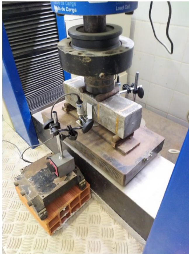
Figura 33 – Vista lateral da instrumentação e posicionamento dos LVDTs.
