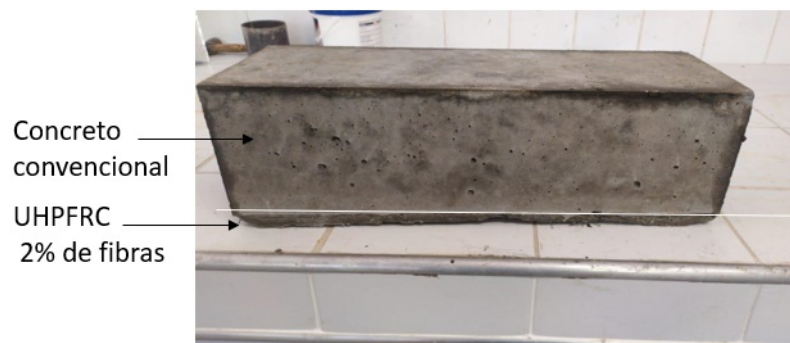
Figura 37 – Camada de 1 cm de UHPFRC como reforço.
