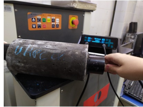
(b) Ultrassom em CP cilíndrico de 10x20cm
