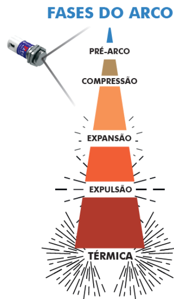
Figura 33 – Aplicação do sensor ótico do relé detector de arco.
