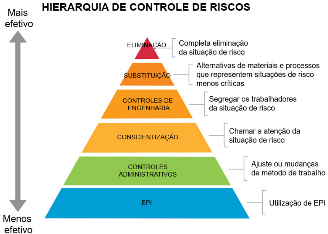
Figura 19 – Hierarquia de controle de riscos (adaptado da NFPA 70E, 2021).
