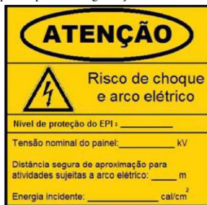
Figura 18 – Exemplo de placa de segurança – Risco de choque e arco elétrico.
