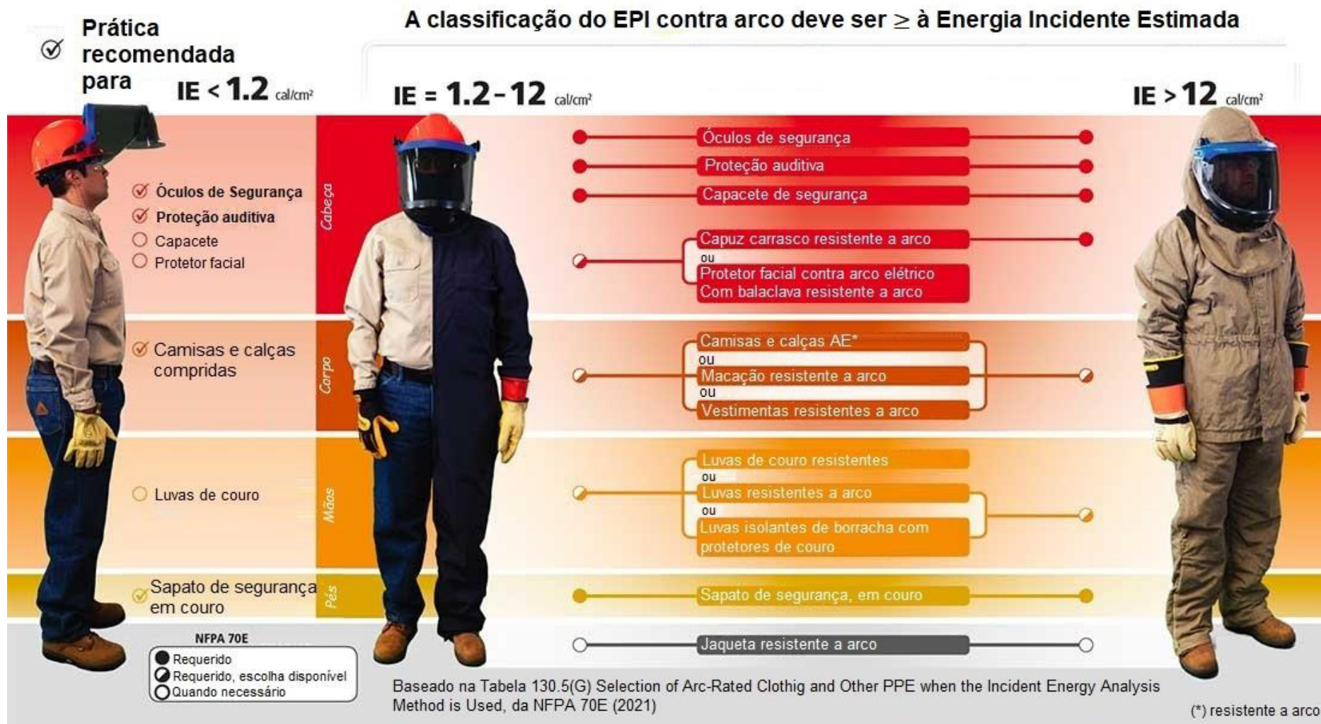
Figura 39 – Vestimentas de proteção e EPIs contra arco elétrico a partir Método da Análise de Energia Incidente.
