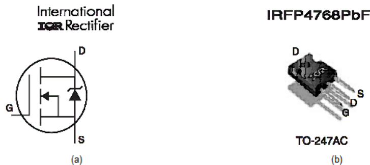
Figura 20 – (a) símbolo do MOSFET, (b) tipo de encapsulamento do MOSFET.
