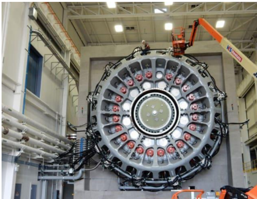
Figura 4 – Turbina de transmissão direta sendo testada na Universidade de Clemson, na Carolina do Sul
