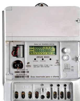
Figura 2 - Medidor inteligente eletrônico de energia da fabricante Eletra.
