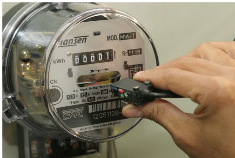
Figura 1 - Medidor eletromecânico de energia da fabricante Nansen.
