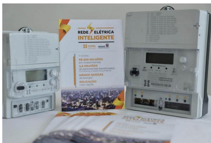
Figura 10 - Medidor eletrônico inteligente Zeus da fabricante Eletra Energy Solutions.
