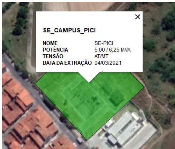
Figura 16 – SE 69-13.8 kV Campus do Pici
