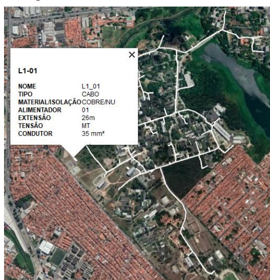
Figura 14 – Camada dos Condutores
