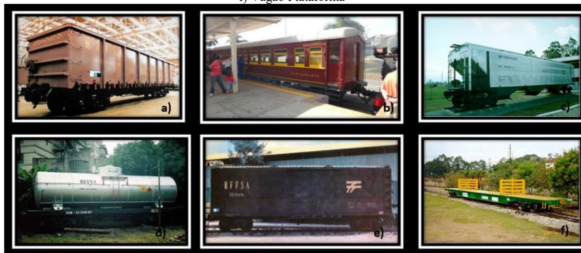
Figura 17. Tipos de vagões: a) Vagão aberto; b) Vagão Carro; c) Gôndola; d) Vagão Tanque; e) Vagão fechado; f) Vagão Plataforma
