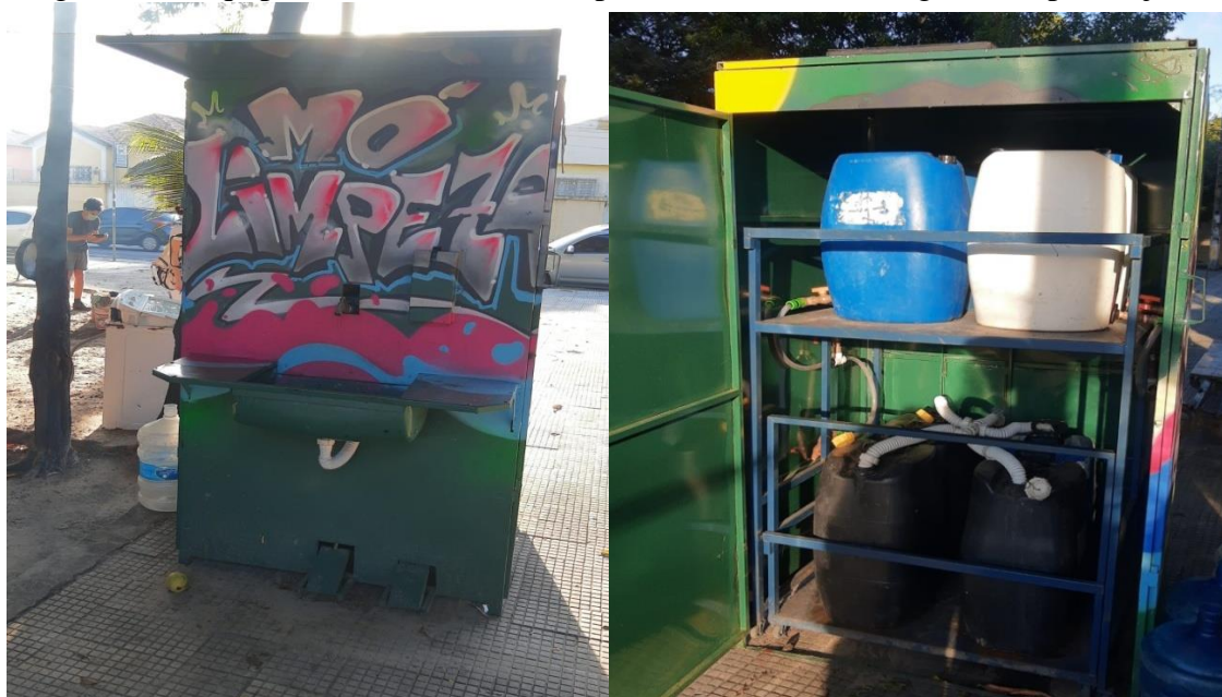
Figura 11 – Equipamento constituído de pia e reservatórios de águas (limpa e suja)
