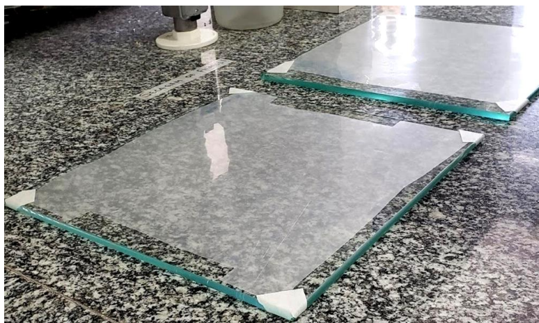
Figura 6 – Filmes de amido dispostos em placas de vidro ( casting )
