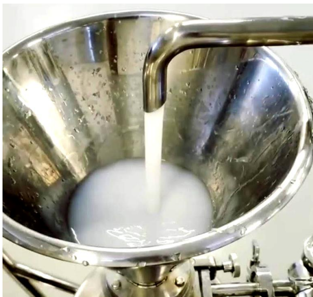
Figura 5 – Solução de CB nanofibrilada em moinho coloidal
