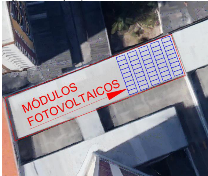
Figura 11 - Disposição dos módulos sobre o telhado.
