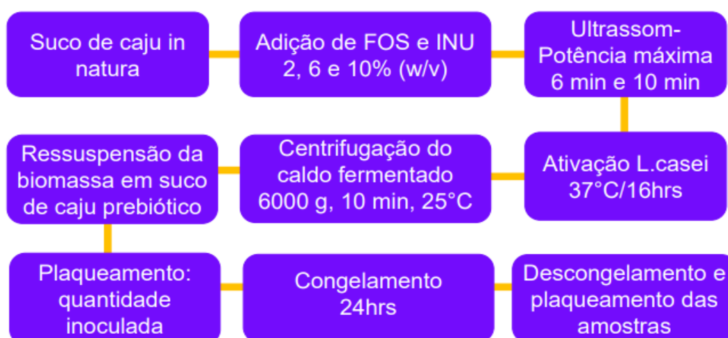
Figura 3- Resumo gráfico das etapas para obtenção das amostras de gelado simbiótico.
