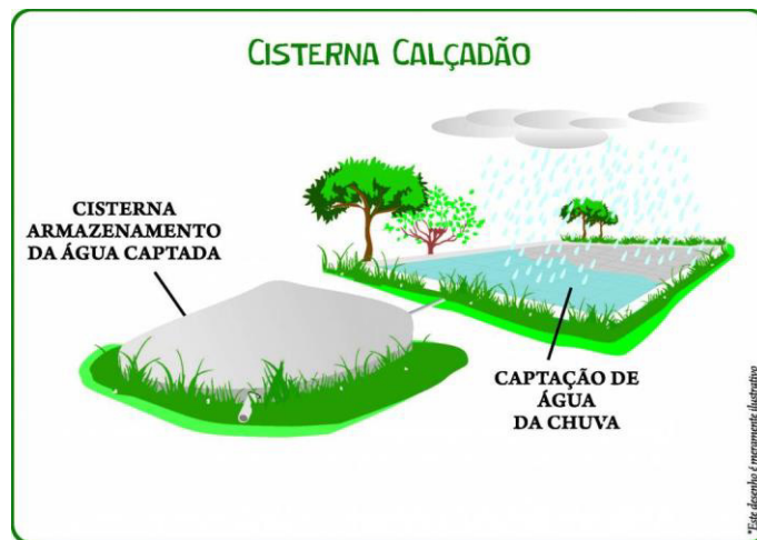
Figura 2. Ilustração da Cisterna Calçadão.
