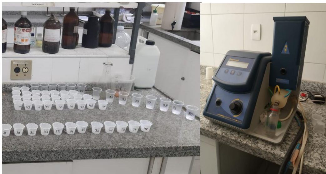
Figura 7 – Determinação dos teores de \text{Na}^+ e \text{K}^+ pelo método de fotometria de chama.
