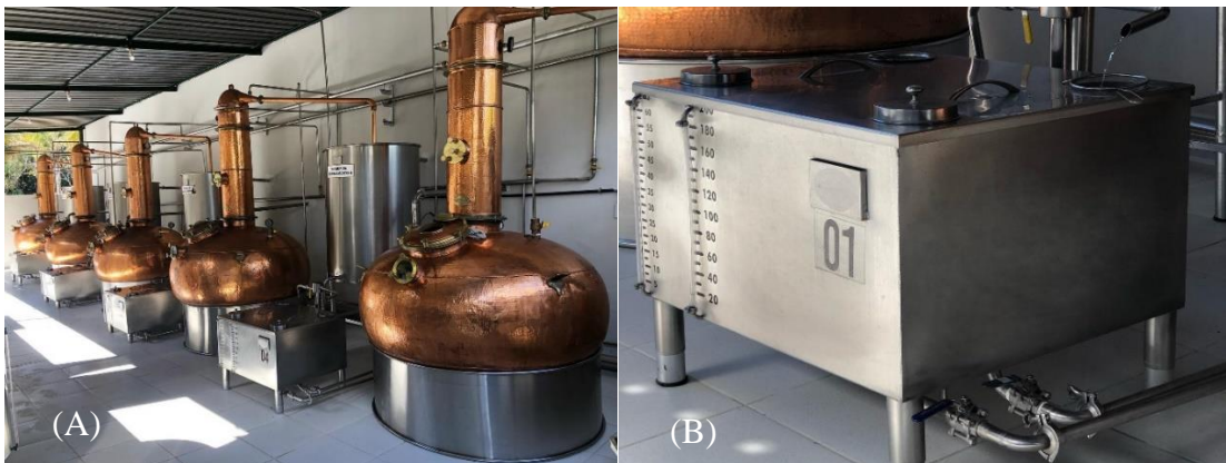
Figura 16 - Equipamentos para a etapa de destilação. (a) alambique de cobre com tanque de resfriamento. (b) caixa coletora de aguardente
